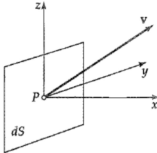
La portata volumetrica che attraversa l'elemento di superficie  $dS$  perpendicolare all'asse  $x$  è  $v_x dS$
