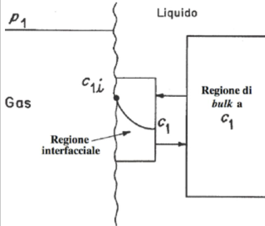
È un'estensione della teoria della penetrazione, con cui si assume che i volumetti di fluido (in cui avviene la penetrazione di materia) sono presenti in superficie per un certo tempo prima di essere riassorbiti dal *bulk*
