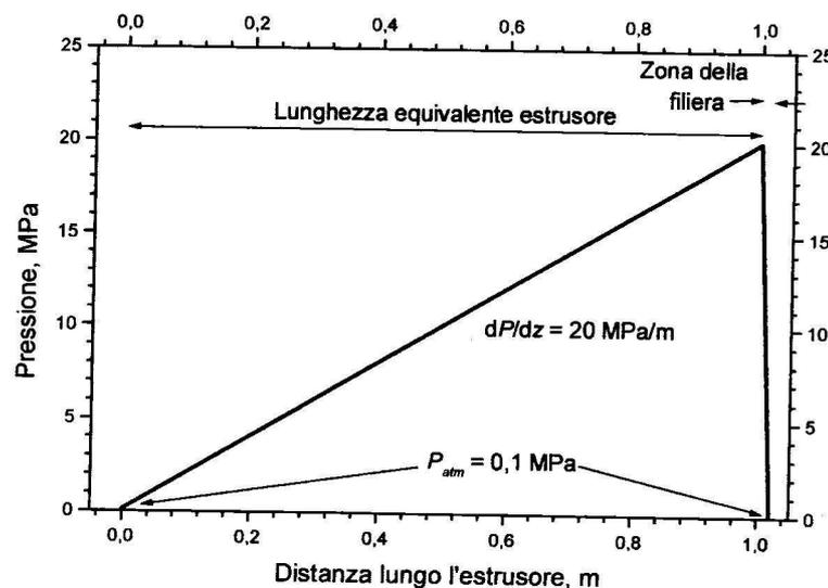
Il flusso di materiale dovrà quindi avvenire *contro* un gradiente di pressione. La quantità di moto necessaria al trasferimento sarà fornita al materiale dal movimento della vite.
