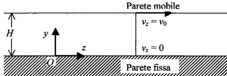
La parete del mantello è la parete fissa in corrispondenza della quale la componente assiale della velocità è nulla ( $v_z(y=0) = 0$ ) in seguito dell'ipotesi di non scorrimento ("no slip condition"). La parete della vite è la parete mobile, che si muove con velocità  $v_0$ , comunicandola al materiale per cui  $v_z(y=H) = v_0$ . La distanza tra vite e mantello è  $H$ .
