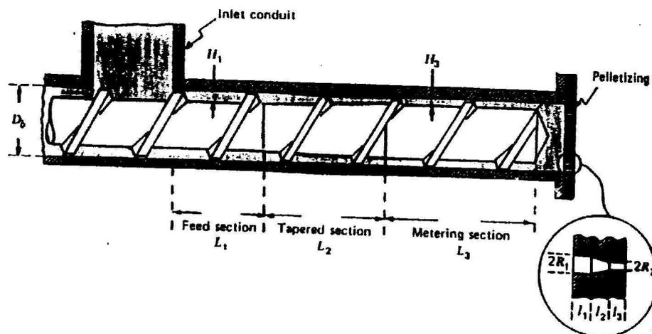
Il passaggio del materiale attraverso la filiera richiede un'elevata differenza di pressione, per cui il profilo di pressione nell'estrusore è del tipo riassunto nella figura sottostante.
